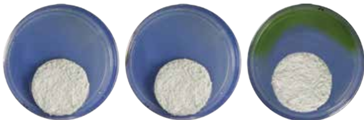
Rast rias na omietke PCI Multiputz® NoBio Z
